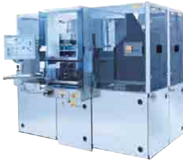
Das Segment Substrat Bonder ist das drittgrößte Geschäftsfeld von SÜSS. Das Substrat- oder Waferbonden ist ein Fügeprozess, bei dem zwei oder mehrere strukturierte Wafer zum Beispiel mittels Wärme und Druck verbunden werden, um einen mikromechanischen Chip herzustellen.
